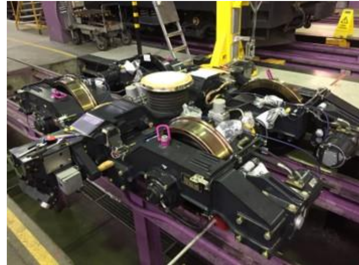
La version actuelle, fabriquée par Alstom. Poids: 3,9 tonnes.
