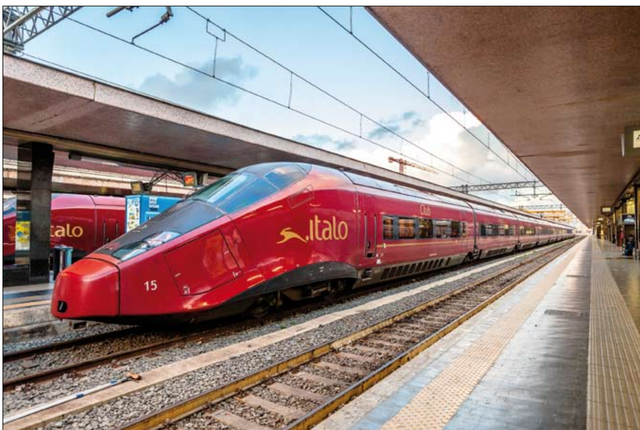
Les rames à grande vitesse Italo de type ETR 575 ont été construites par Alstom. Elles appartiennent à la société italienne Nuovo Trasporto Viaggiatori (NTV) propriété du groupe MSC. Voici l'unité 15 en gare de Rome Termini le 12 mai 2016. Photo: Benny Marty
