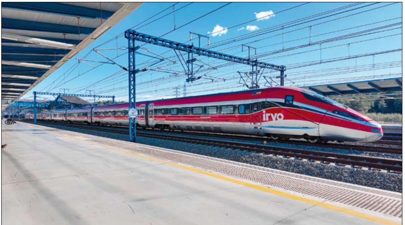
Une rame ETR 1000 traverse la gare de Tarragone (E) le 6 novembre 2023. Ce matériel roulant, apte jusqu'à 400 km/h, peut être alimenté en courant continu de 1500 ou de 3000 volts ou en courant alternatif de 15 000 ou de 25 000 volts. La marque Iryo appartient à la société espagnole ILSA, filiale de Trenitalia. Photo: Adobe Stock
